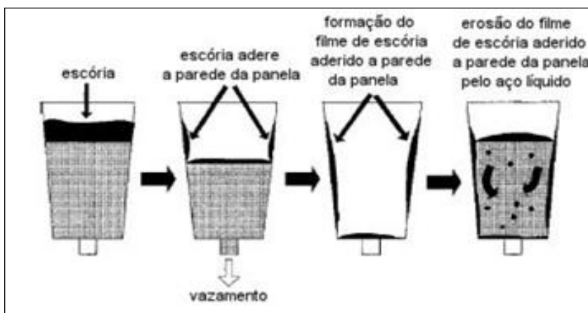
Figura 17 – Mecanismo de formação da camada de escória aderida a parede da panela.
