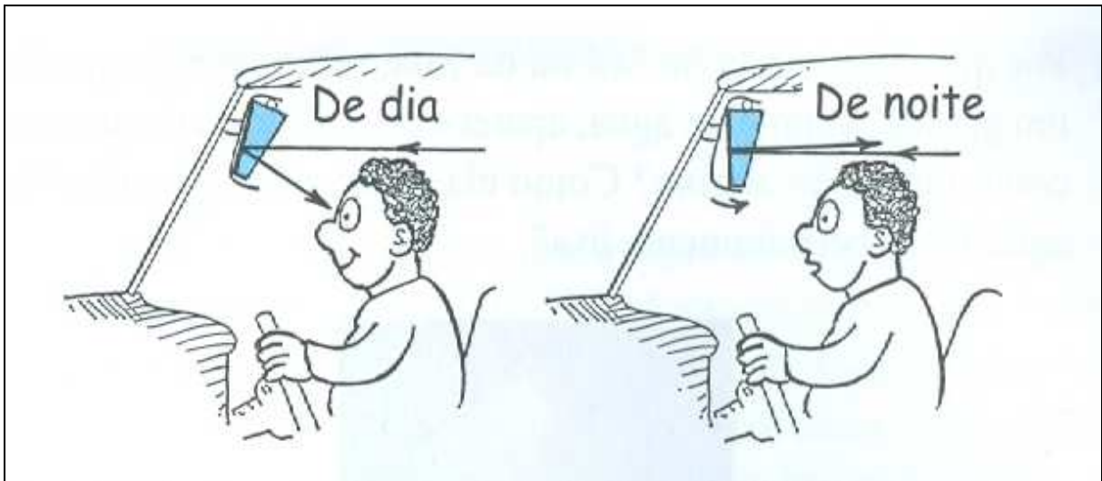
Figura 8.1 - A reflexão no espelho retrovisor, diminuindo o ofuscamento
