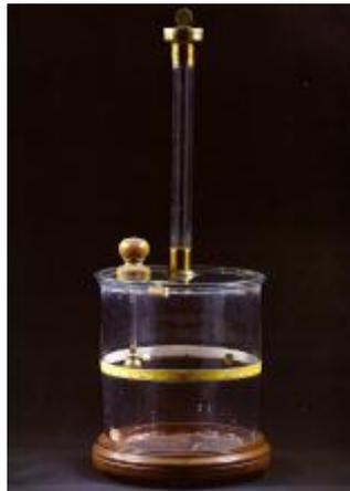
Figura 3 – Modelo de Balança de torção utilizada por Coulomb, feita por vidro, madeira, medula de sabugueiro e latão. (Fonte: <http://museu.fis.uc.pt/129fp.jpg>)
