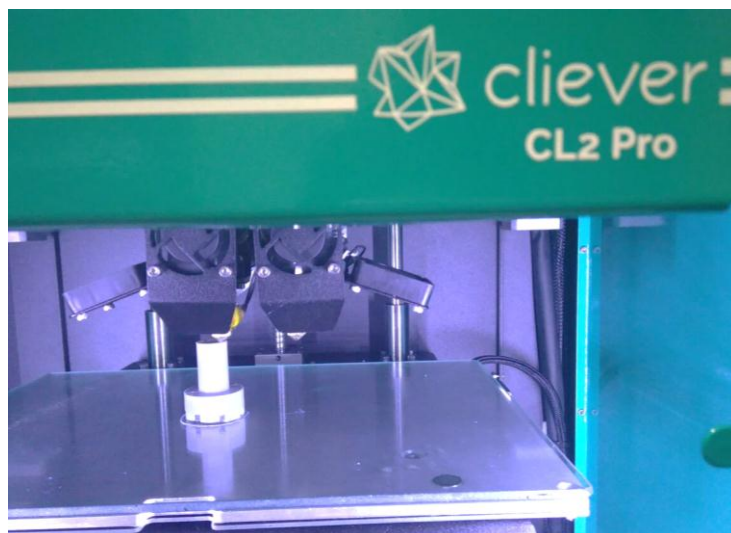
Figura 31 - Impressora 3D imprimindo o gerador de vorticidade.
