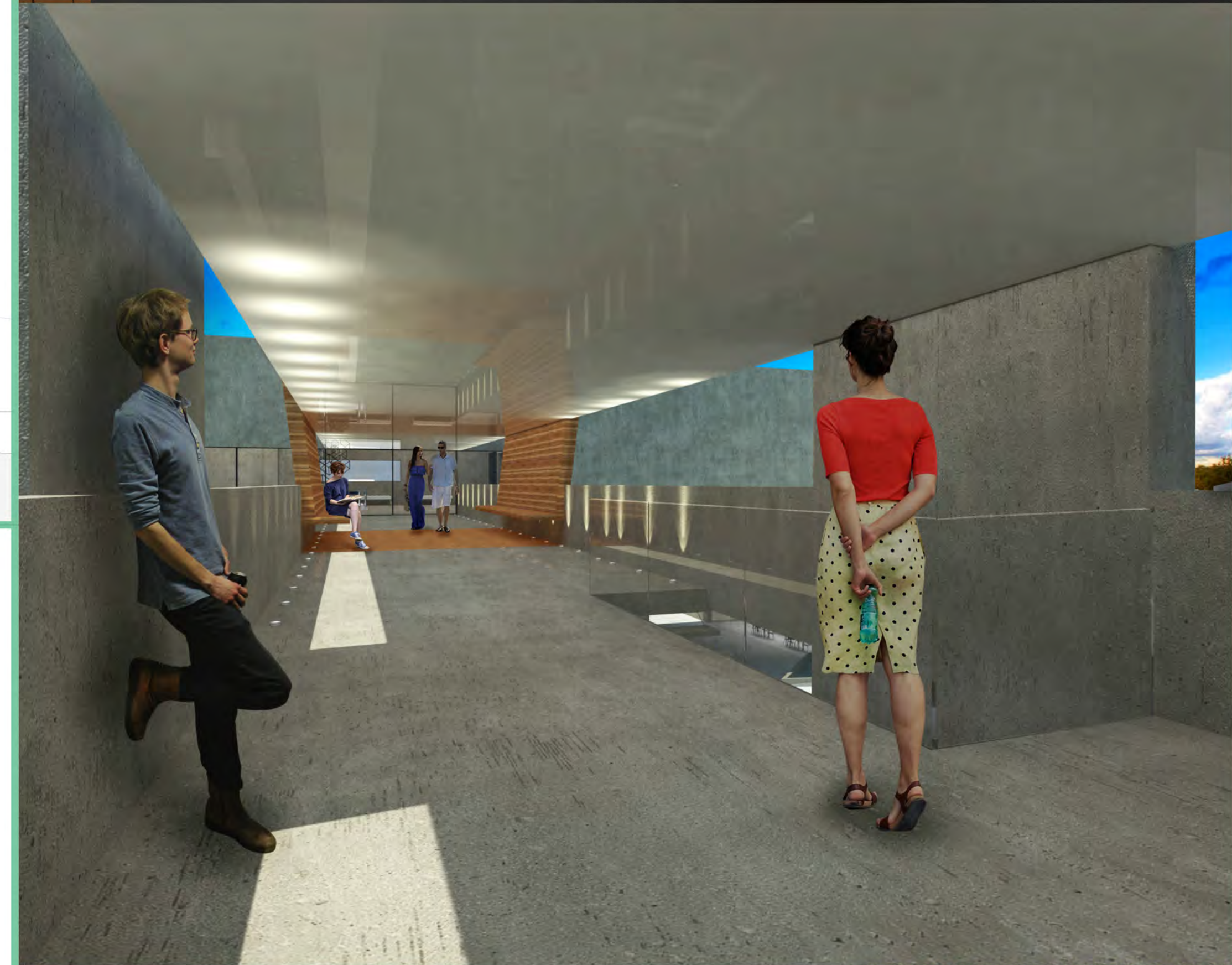
PASSARELA | Perspectiva da passarela que interliga a estação metroviária ao foyer e bilheteria da sala de espetáculos. Possui espaços de permanência e pode ser acessada por meio de escadas pelo canteiro central da avenida.
