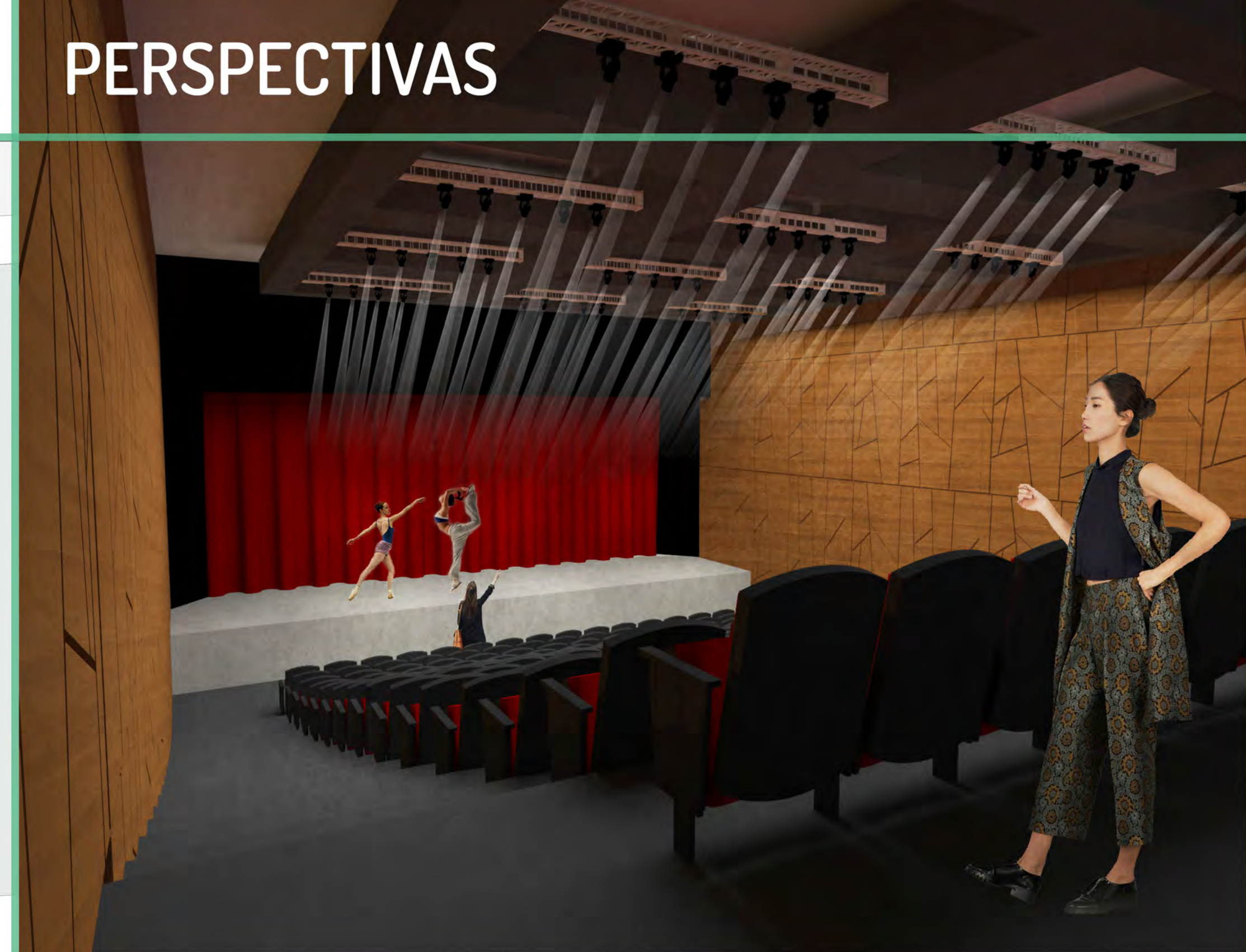
SALA DE ESPETÁCULOS | Sala de Espetáculos com capacidade para 222 pessoas. Nas laterais os painéis amadeirados com frisos e recortes proporcionam melhor desempenho acústico do ambiente, evitando ecos por meio da absorção do som.
