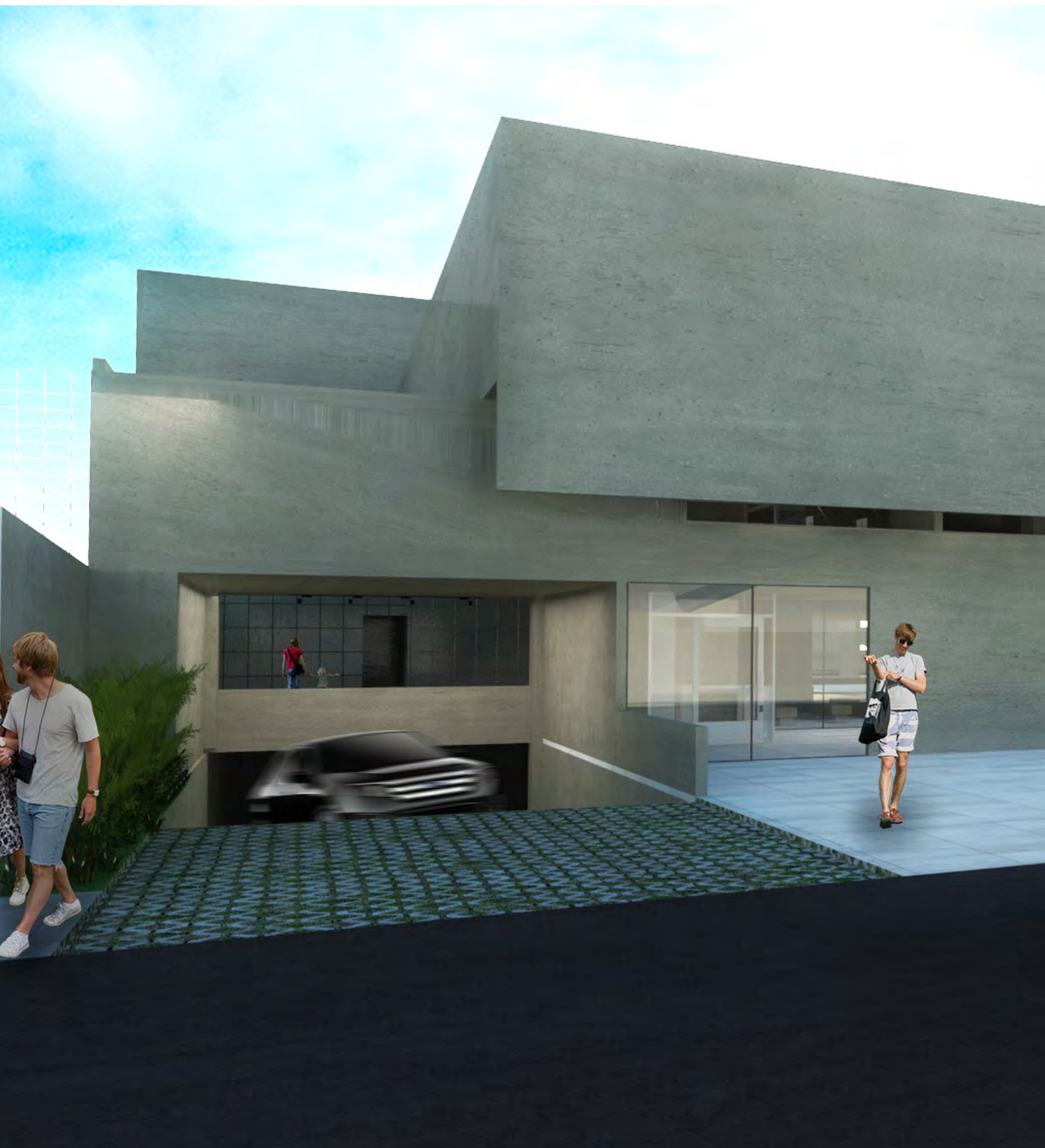
▲ IMG 89 Perspectiva da fachada posterior voltada para rua Capitão Francisco Pedro. À esquerda vê-se o acesso de veículos e acima o volume da biblioteca, com esquadria protegida pelo caimento do bloco de teatro. À direita a passarela conecta os blocos de exposição e oficinas.
