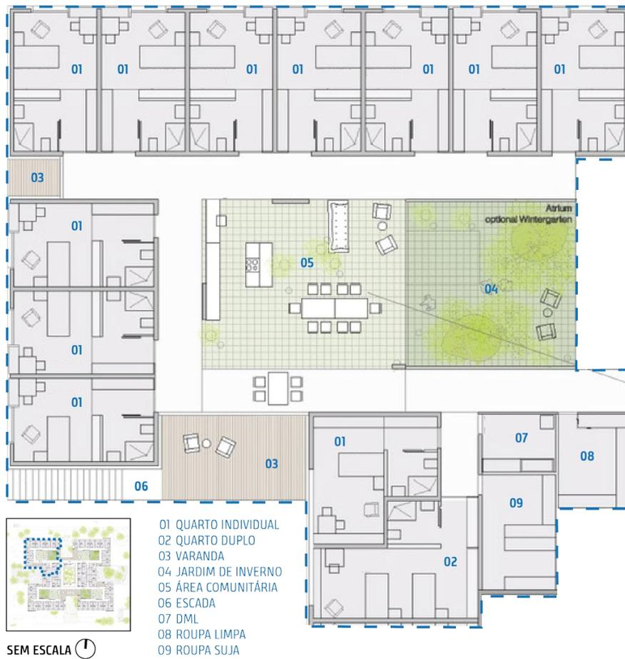
**Figura 18.** Recorte da Planta Baixa do Segundo Pavimento com indicação dos ambientes.
