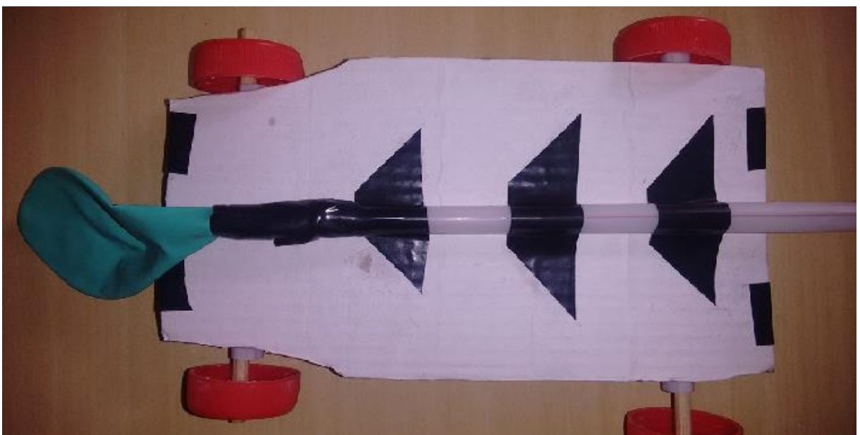
Figura 4.8 – Passo 4. Fixar o “motor” no carrinho.
