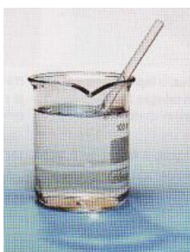
Figura 3.36 - Bastão de vidro imerso em tetracloroetileno ( \text{C}_2\text{Cl}_4 ), ambos têm a mesma refração.
