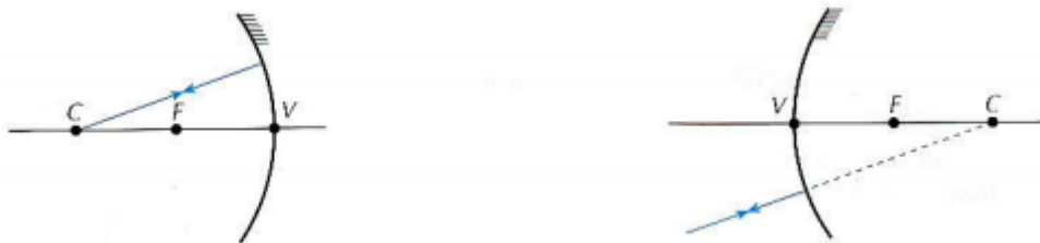
Figura 3.25 – Raios na direção do centro de curvatura refletem sobre si mesmo.
