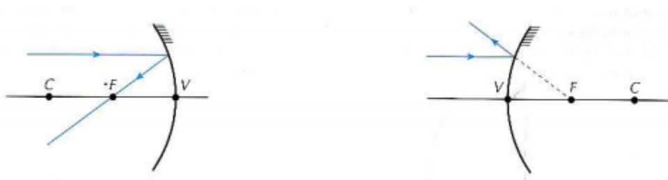
Figura 3.23 – Raios paralelos refletem na direção do foco.
