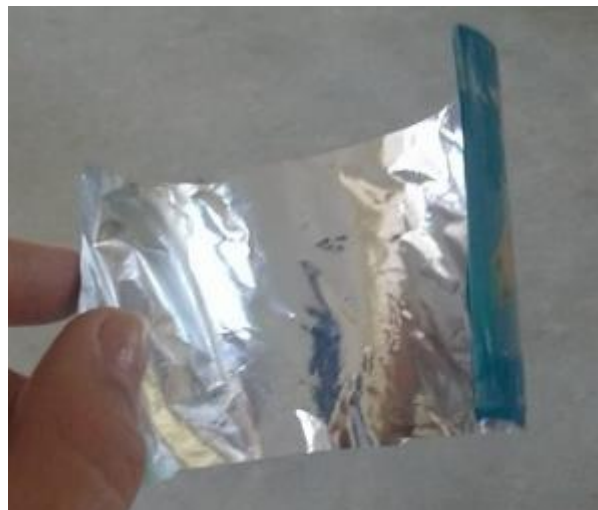
Figura 5.9 – Espelho Côncavo formado pela garrafa e embalagem de salgadinho.
