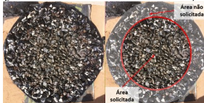
Figura 42 - Área solicitada e não-solicitada no Sweep test
