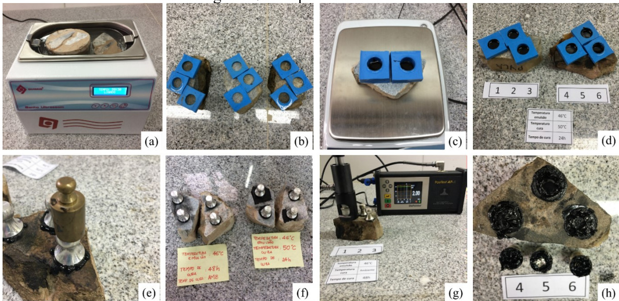
Figura 47 - Etapas do ensaio ABS
