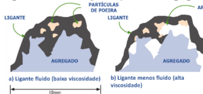
Figura 8 - Efeito da sujeira superficial em agregados
