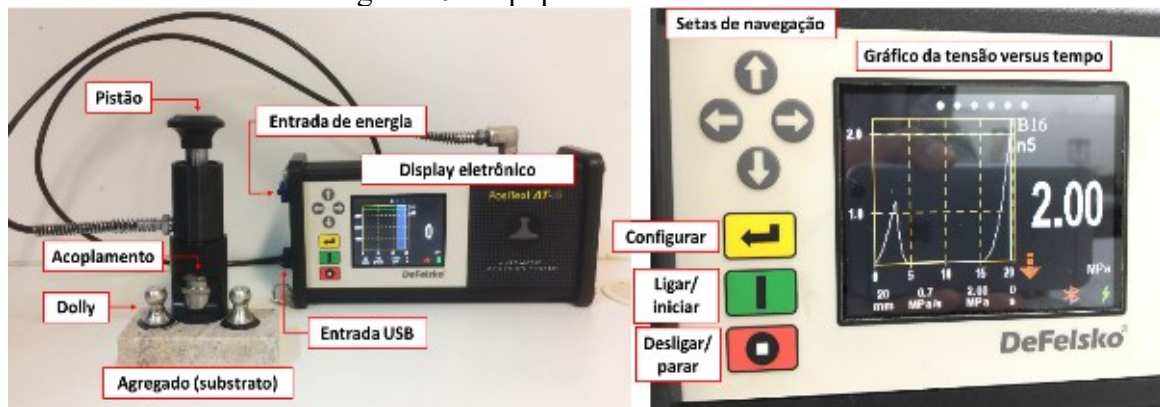
Figura 46 - Equipamento Positest AT-A
