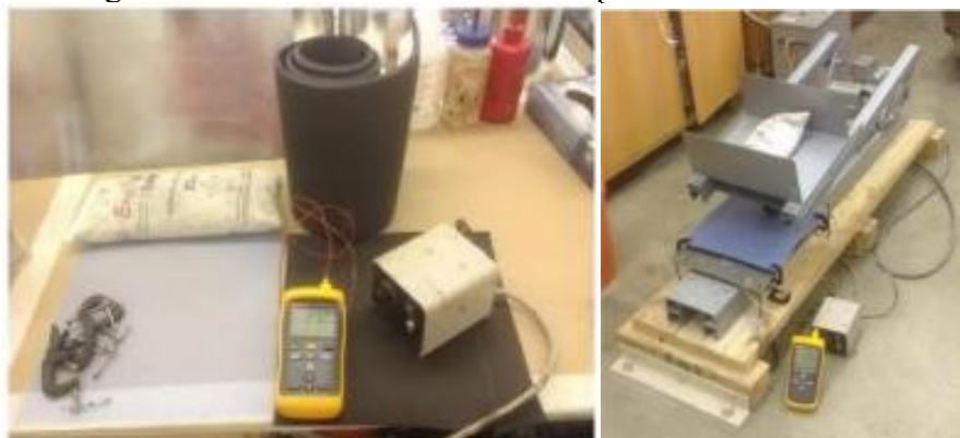
Figura 23 - Ensaio LWT modificado para amostras de TSP
