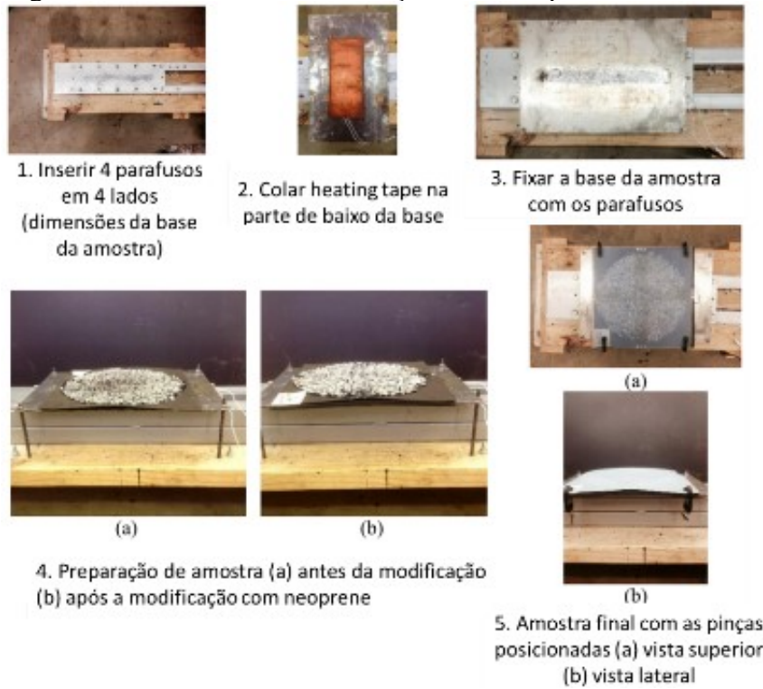
Figura 24 - Processo de modificação do LWT para ensaio de TSP
