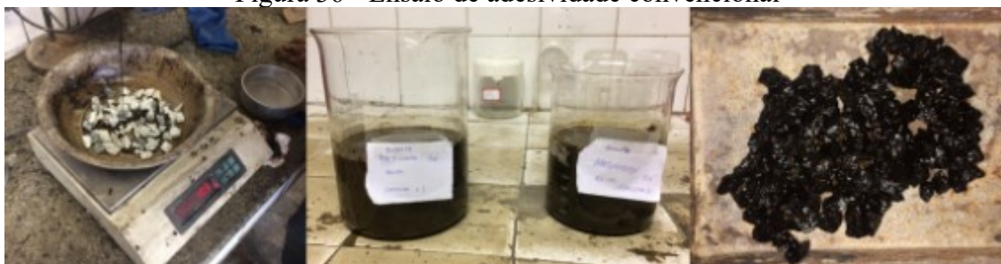
Figura 36 - Ensaio de adesividade convencional
