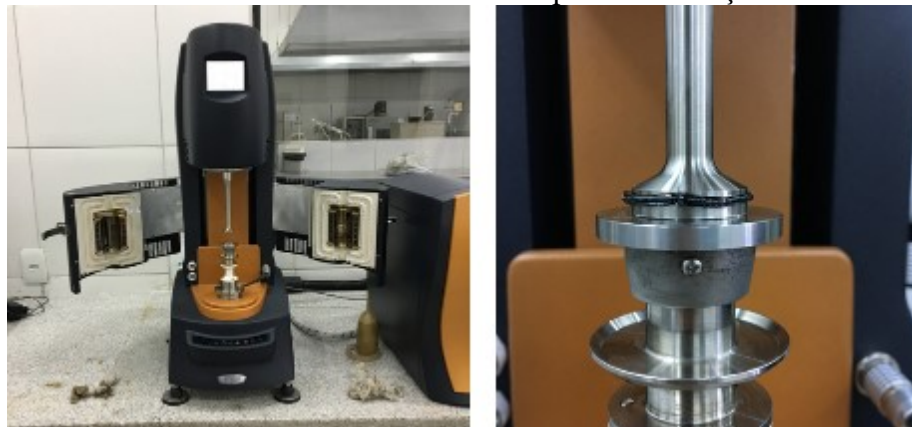
Figura 49 - Reômetro de cisalhamento utilizado para a realização do ensaio MSCR
