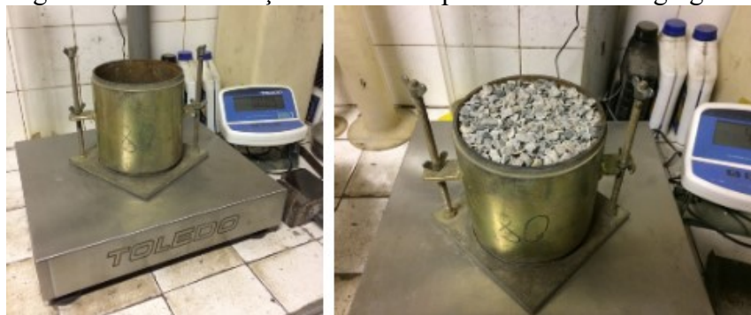
Figura 39 - Determinação da massa específica seca dos agregados
