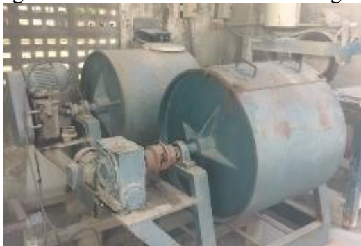
Figura 37 - Ensaio de abrasão Los Angeles
