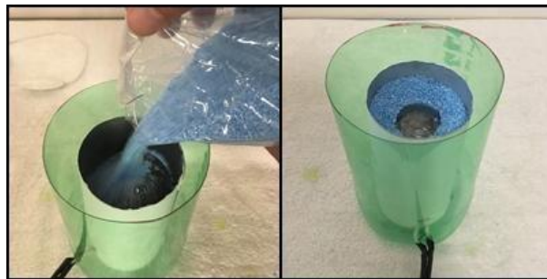
Figura 12: Centralização da lâmpada com areia.
