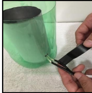
Figura 11: Isolamento dos fios.
