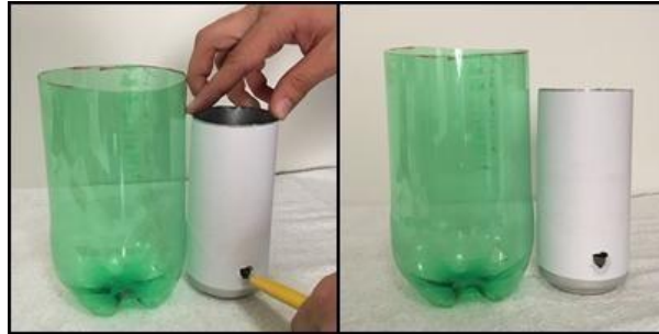
Figura 5: Furos feitos para a passagem dos fios.
