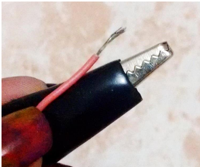
Figura 2: Extremidades dos fios: uma com garras e a outra descascada.
