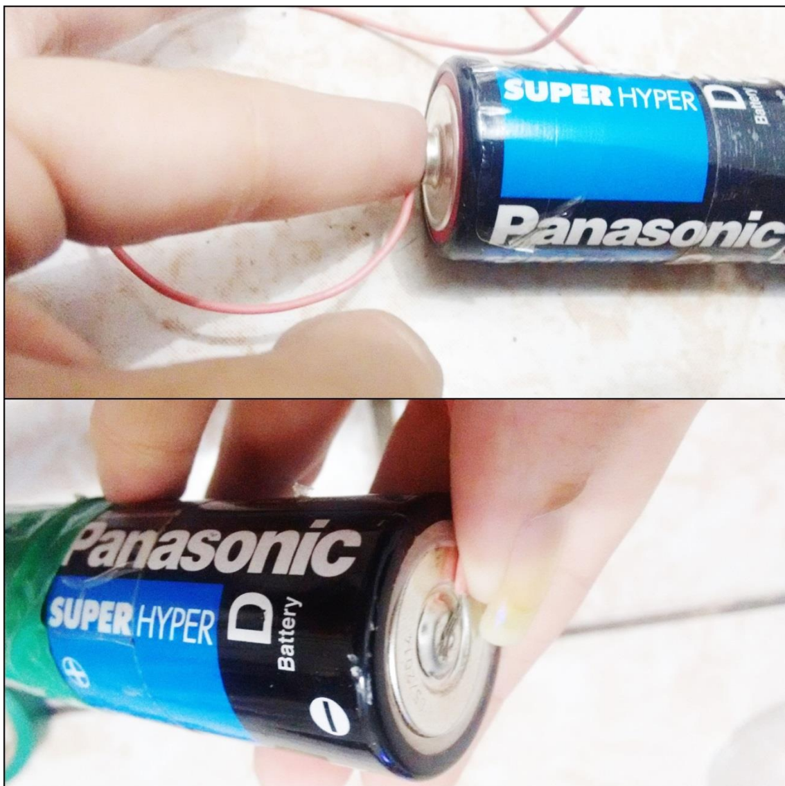
Figura 6: Fios conectados nos polos das pilhas
