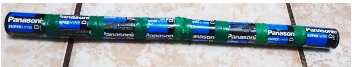
Figura 5: Pilhas associadas em série por meio de fita adesiva.
