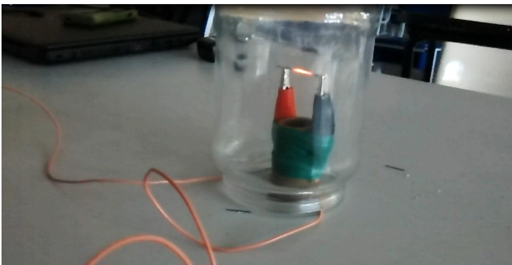
Figura 7b: Mina de grafite a incandescer-se com a passagem de corrente elétrica.
