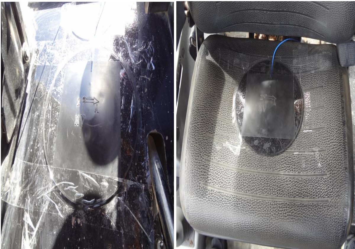
Figura 13 - Acelerômetro fixo ao piso da plataforma e fixo no assento
