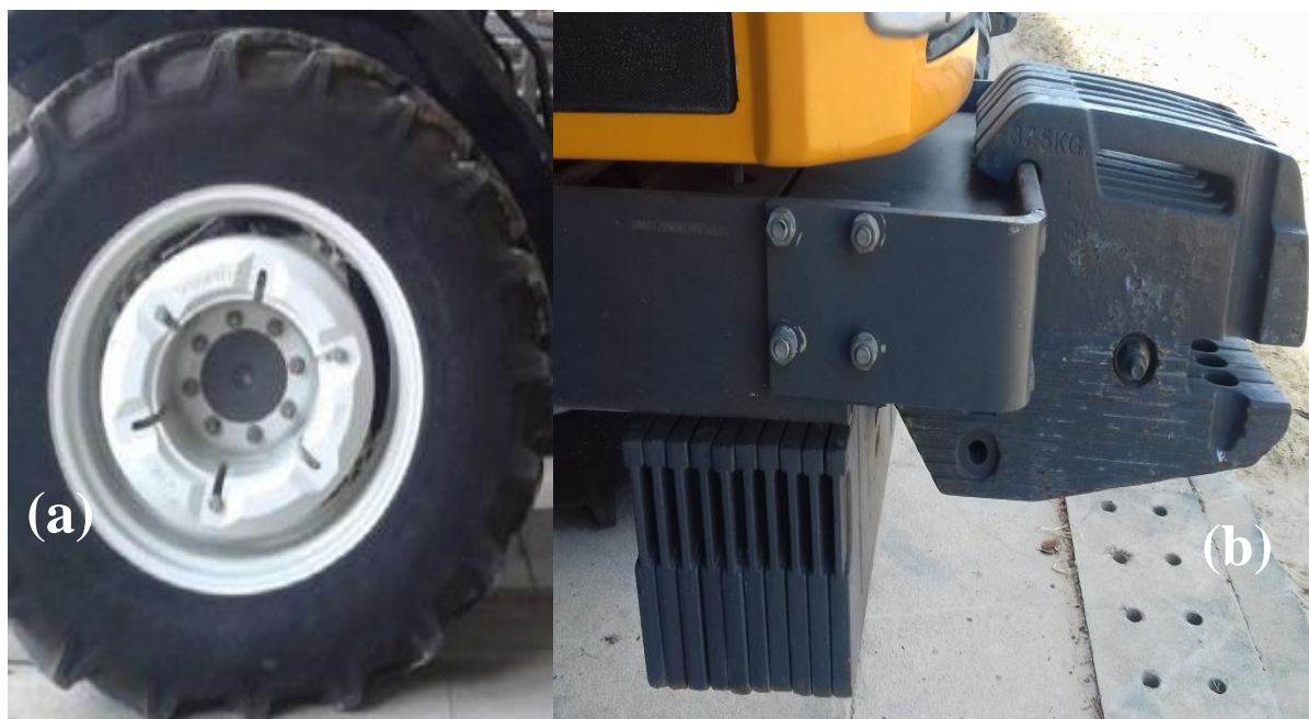
Figura 11 - Localização dos lastros sólidos no eixo traseiro (a) e no eixo dianteiro (b)
