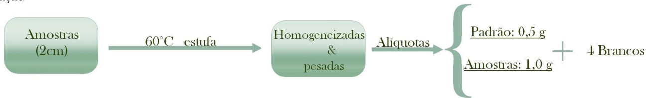
Fig.5 Fluxograma das análises de metais em sedimentos das áreas em estudo.
