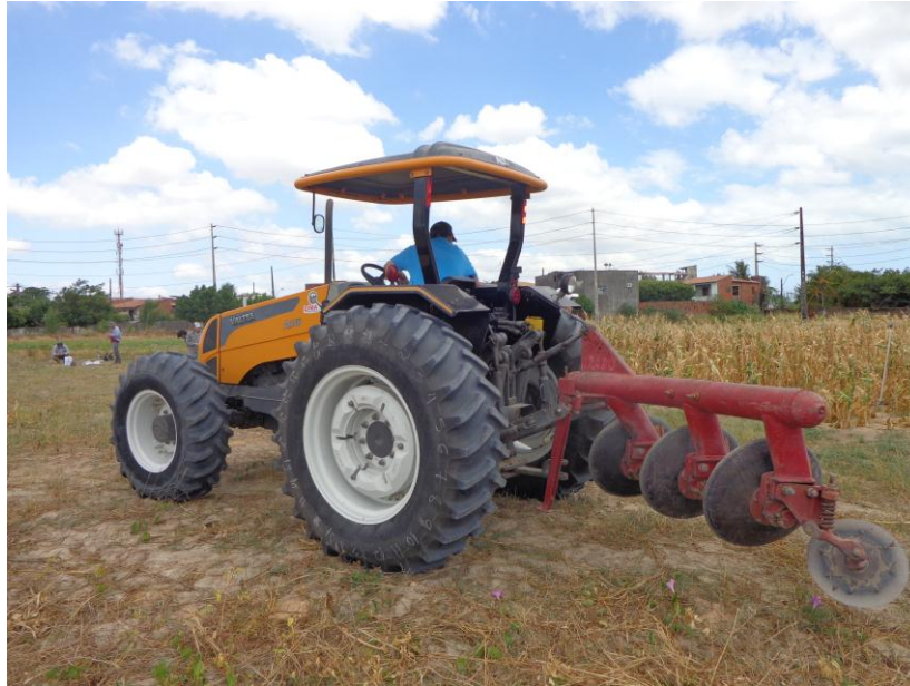
Figura 2: Arado de disco acoplado ao trator 4x2 TDA modelo VALTRA A950.
