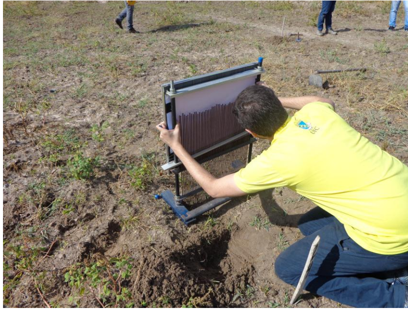
Figura 6: Leitura do dado utilizando perfilômetro em campo.
