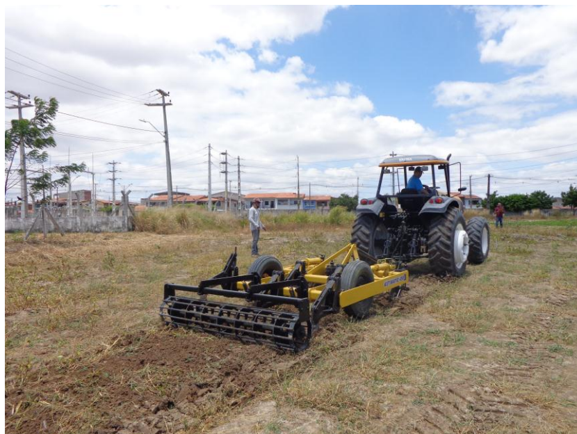
Figura 3: Subsolador Ast Matic 450 acoplado ao trator 4x4 TDA modelo VALTRA BM120.
