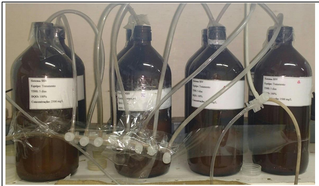
Figura 6. Reatores usados para o tratamento aeróbio do efluente da produção anaeróbia de ácido caproico.
