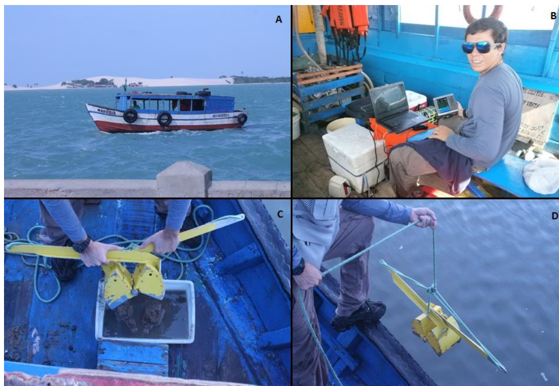
Figura 3. Saída de Campo para coleta de dados batimétricos e amostras de sedimento. a. Embarcação (Maresia). b. Sistema de aquisição de dados batimétricos com ecobatímetro. c. Amostra coletada pela VanVeen. d. Amostragem de sedimento utilizando um amostrador de fundo do tipo VanVeen.
