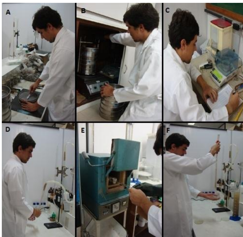
Figura 7. Análise das amostras de sedimento no laboratório. a. Separação das frações das amostras por peneira. b. Peneiramento Mecânico. c. Pesagem das amostras. d. Análise de carbonato de cálcio. e. Mufla. f. Pipetagem.
