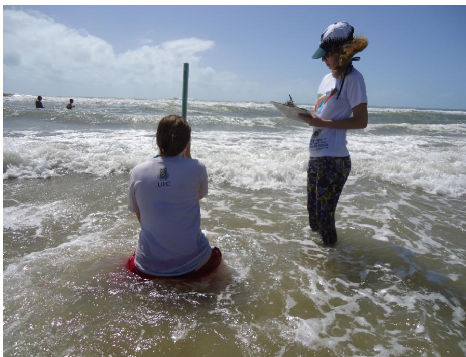
Figura 03 – Demonstração da medida da altura da onda na arrebentação (Hb), através da leitura da mira.
