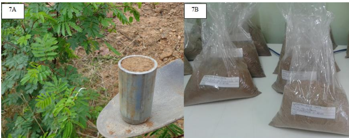
Figura 7 - Coleta de amostra indeformadas (7A) e deformadas de solo efetuadas nos sítios estudados (7B)
