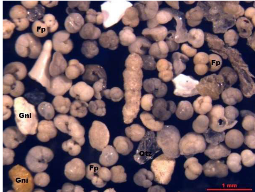
Figura 5.32 – Foraminíferos planctônicos e bentônicos do testemunho ANP 1285, vistos em lupa binocular: Fp – Foraminífero plantônico; Fb – Foraminífero bentônico; Qtz – Quartzo; Gni – Grãos não identificados.
