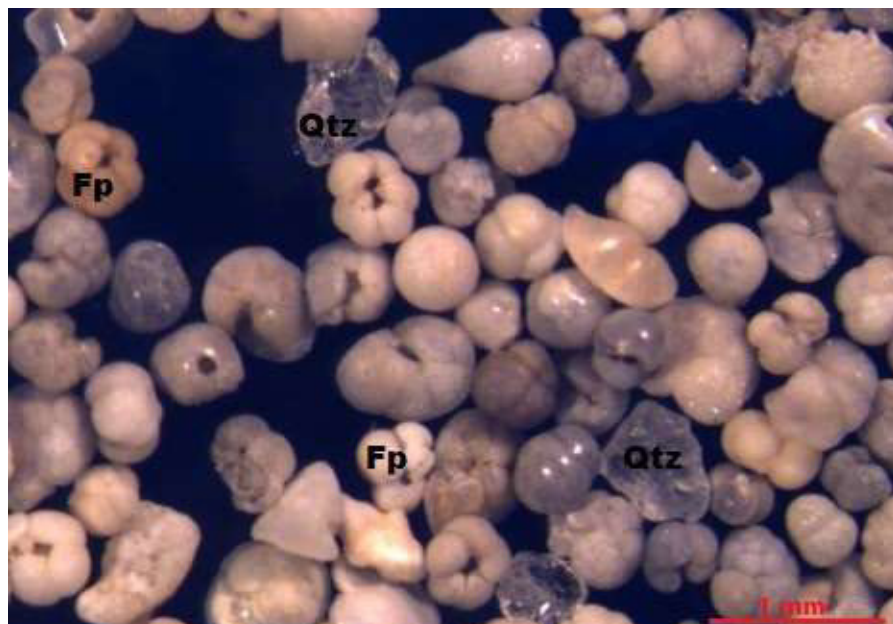
Figura 5.33 – Foraminíferos planctônicos e grãos de quartzo do testemunho ANP 1285, vistos em lupa binocular: Fp – Foraminífero plantônico; Qtz - Quartzo.
