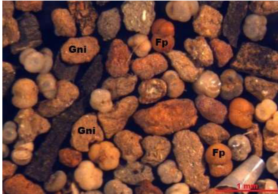
Figura 5.16 – Foraminíferos planctônicos de coloração amarelada e grãos alterados com sinais de oxidação do testemunho SIS 699, vistos em lupa binocular: Fp – Foraminífero planctônico; Gni – Grãos não identificados.
