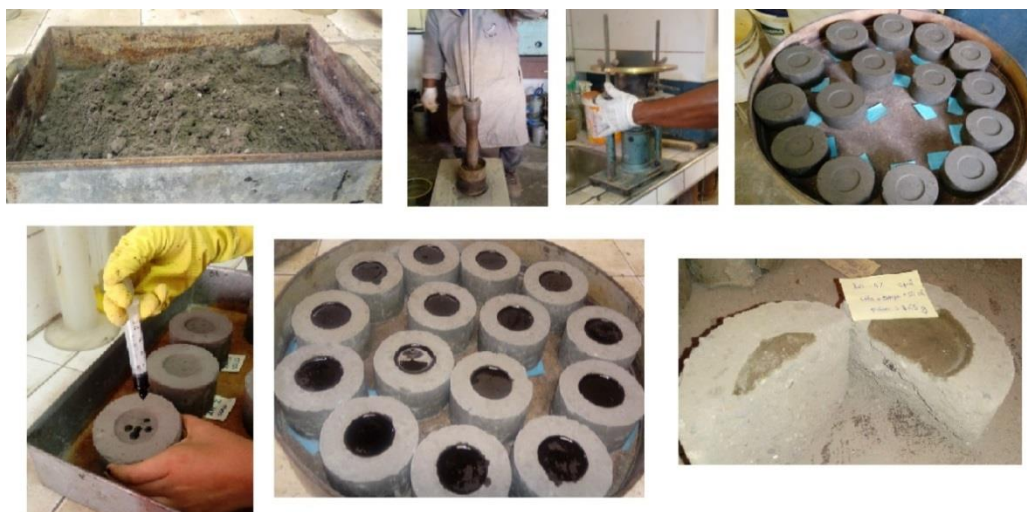
Figura 25 - Etapas do ensaio de Imprimação
