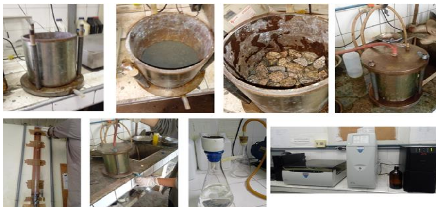
Figura 29 - Ensaio de lixiviação em amostra compactada
