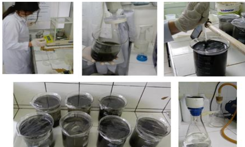
Figura 28 - Ilustração do ensaio de solubilização
