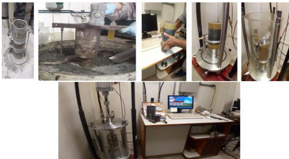
Figura 22 - Ilustração da realização do ensaio de MR
