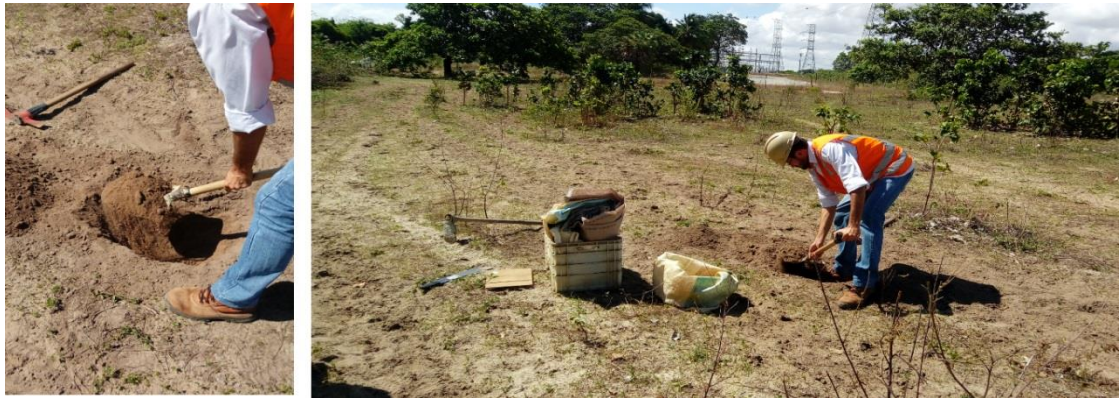
Figura 33 - Reconhecimento de Subleito (Coleta de Amostras)
