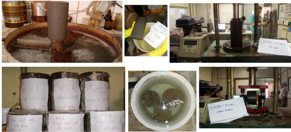
Figura 23 - Ilustração da realização dos ensaios de RCS e RT
