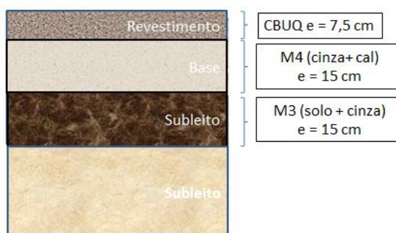
Figura 78 - Estrutura 2 para o pavimento com N = 10^7
