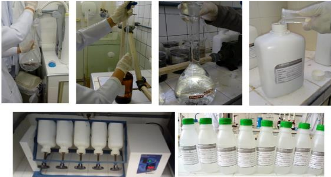
Figura 27 - Ilustração da realização do ensaio de lixiviação
