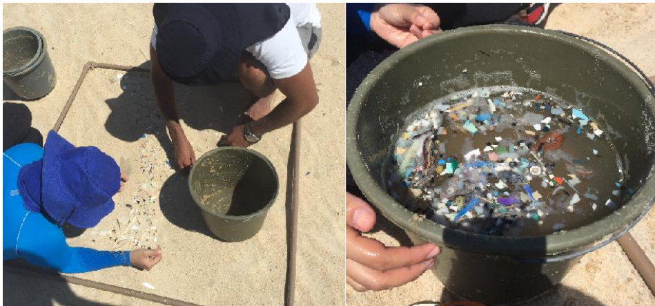
Figura 8. Demonstração de coleta de sedimento e separação dos pellets por flotação.
