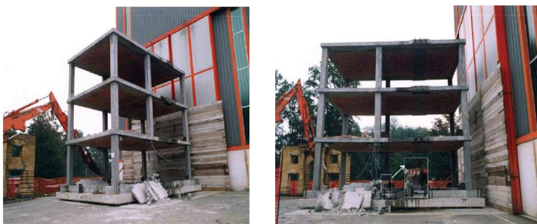
Figura 4 – Retirada dos pilares central em um modelo experimental
