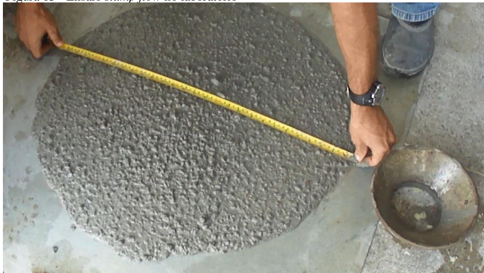
Figura 13 - Ensaio slump flow no laboratório
