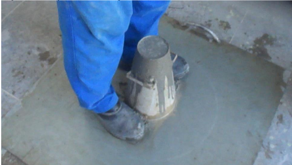
Figura 1 - Execução do ensaio de espalhamento
