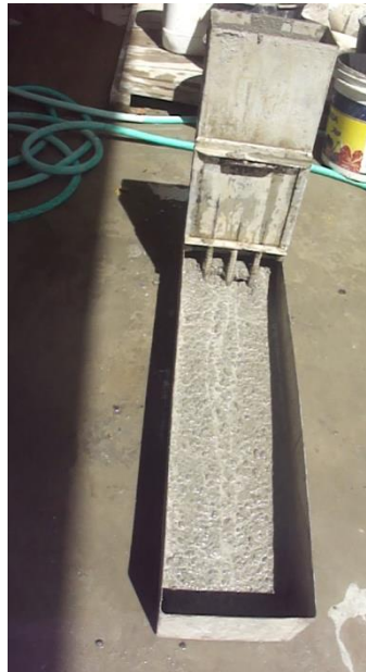
Figura 15 - Ensaio Caixa em L em laboratório
