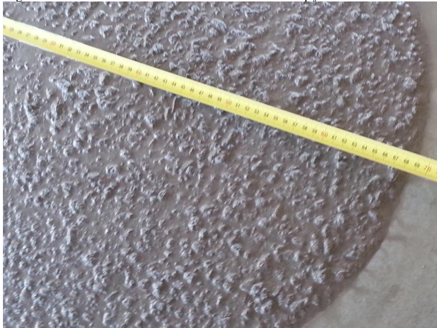
Figura 19 - Foco na extremidade do CAA no ensaio slump flow
