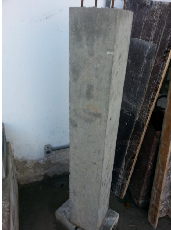
Figura 17 - Aspecto do pilar confeccionado em laboratório
