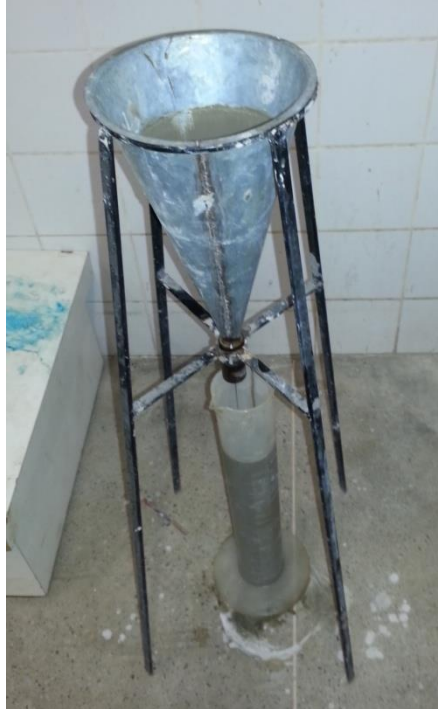
Figura 11 - Ensaio Cone de Marsh em laboratório
