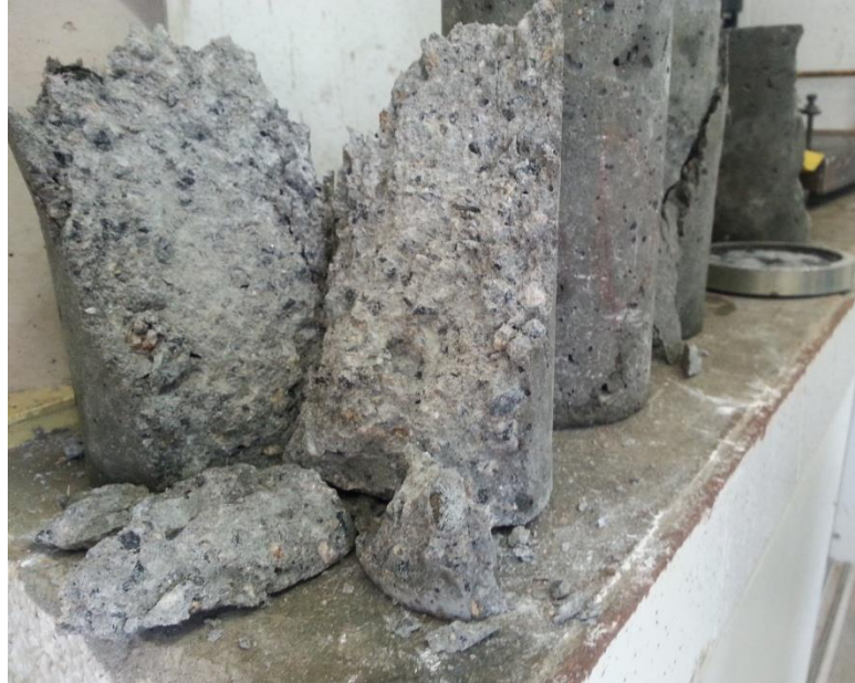
Figura 16 - Aspecto do corpo de prova de CAA
