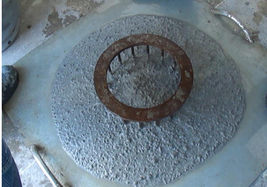
Figura 14 - Ensaio Anel J no laboratório
