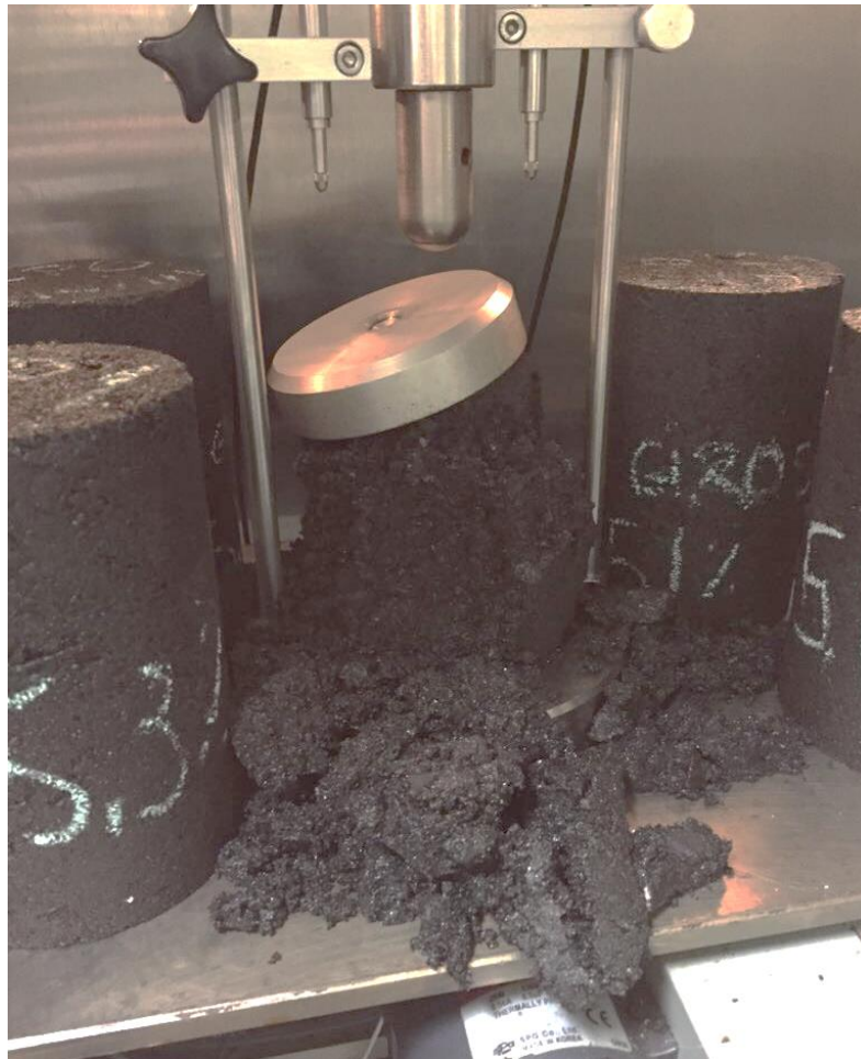
Figura 24. Corpo de prova submetido à tensão de 600kPa em ensaio uniaxial de carga repetida.
