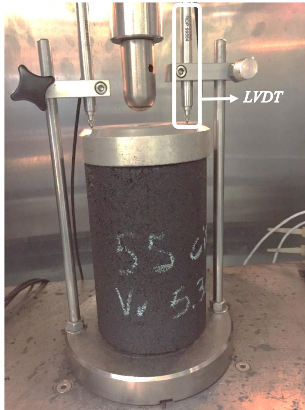
Figura 11. Acomodação do corpo de prova e posicionamento dos LVDTs.
