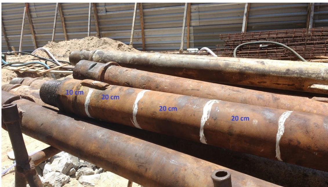
Figura 4.31 – Haste de escavação seccionada em quatro trechos para o monitoramento.
