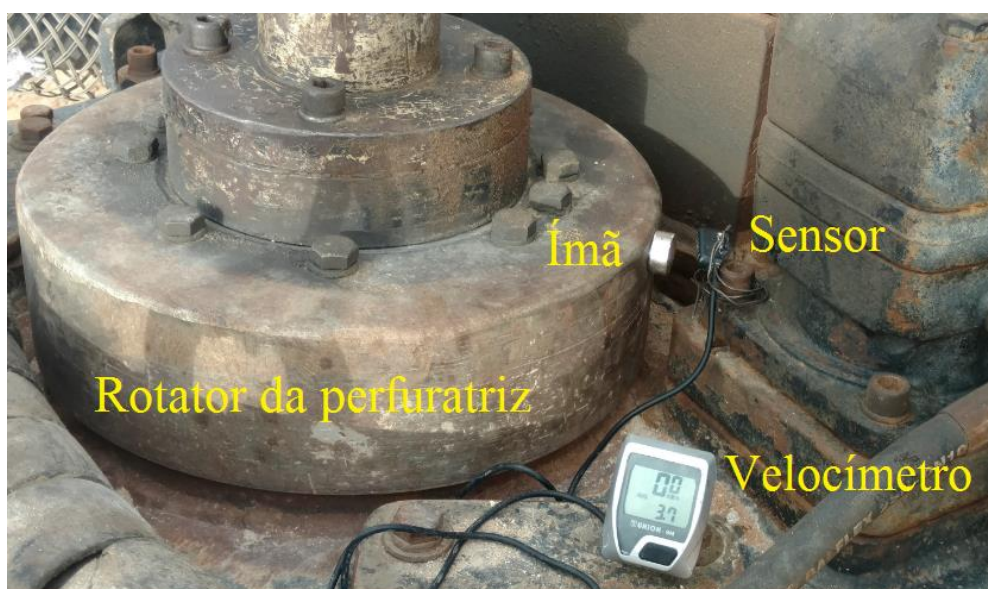
Figura 3.9 – Equipamento utilizado por Monteiro (2016) para o monitoramento das estacas raiz
