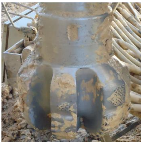
Figura 3.6 – Broca 1000, com diâmetro de 31 cm
