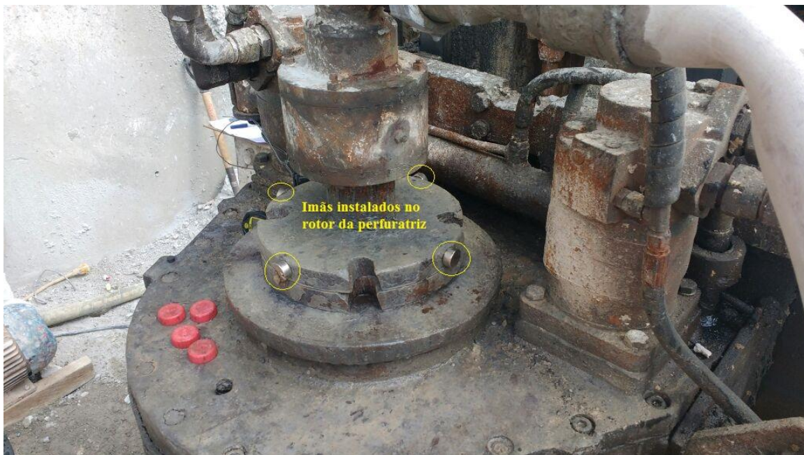
Figura 4.27 – Quatro ímãs posicionados diametralmente opostos no rotor da perfuratriz
