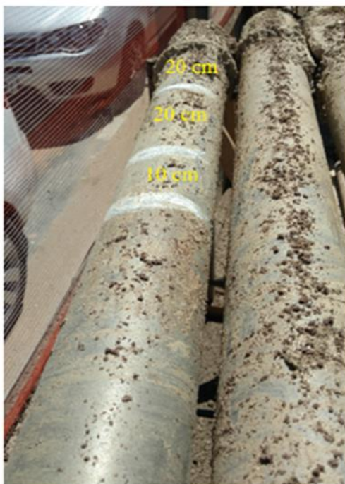
Figura 4.30 – Haste de escavação seccionada em três partes por Monteiro (2016).
