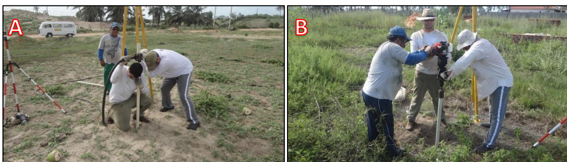
Figura 2.3: Processo de aquisição de dados através da testemunhagem do substrato. Em (A) foi usado o vibrotestemunhador convencional, e em (B) foi usado o martelete com adaptação. Fonte: o autor.
