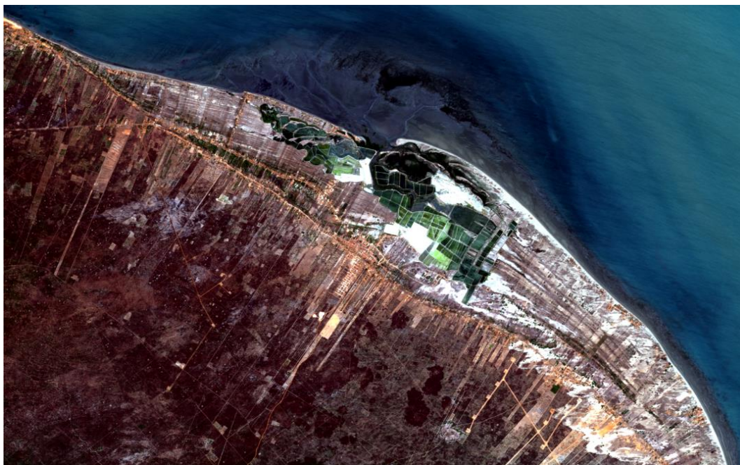
Figura 3.1: A composição R4-G3-B2 (cor real) identificou feições continentais e marinhas com cores mais próximas da realidade e melhor resolução espacial. Logo, nesta imagem podem ser destacadas as principais feições geomorfológicas, como a zona estuarina (hoje ocupada pelas salinas, tanques de carcinicultura e pela zona de manguezal), as barreiras e o banco de algas junto à costa.
