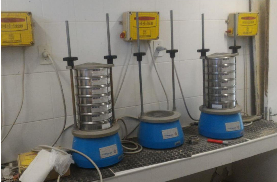
Figura 2.7: Amostras submetidas ao ensaio de peneiramento usando as peneiras de 1000 \mu\text{m} (0 \Phi ), 500 \mu\text{m} (1 \Phi ), 250 \mu\text{m} (2 \Phi ) 125 \mu\text{m} (3 \Phi ), 63 \mu\text{m} (4 \Phi ) (de cima para baixo, nesta sequência). Fonte: o autor.
