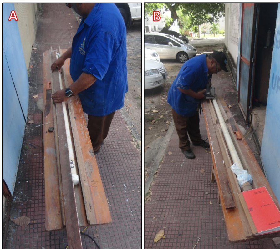
Figura 2.5: Preparação dos canos (A) para o processo de serragem e abertura (B), possibilitando a descrição dos testemunhos. Fonte: o autor.
