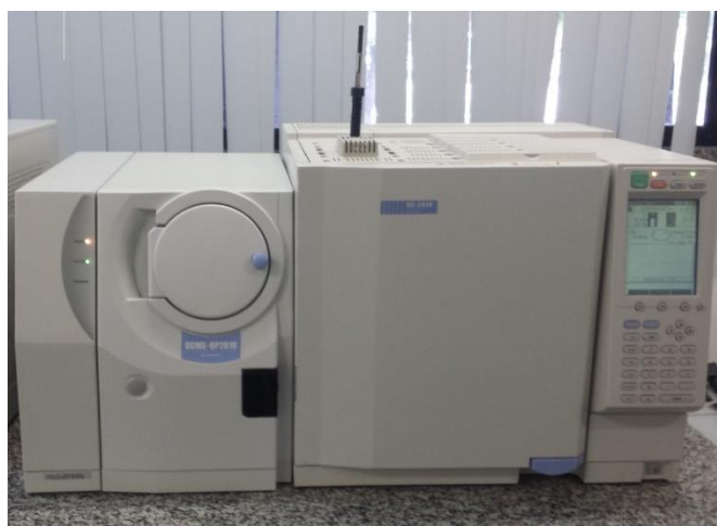
Figura 13 - Dessorção térmica dos voláteis diretamente no injetor do cromatógrafo gasoso acoplado a espectrômetro de massas a partir da fibra de SPME
