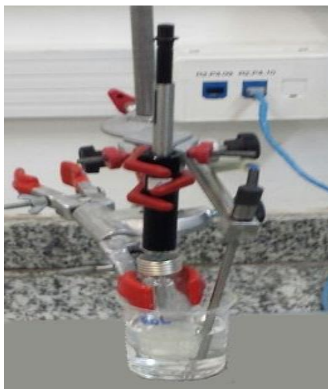
Figura 12 – Extração dos compostos voláteis do headspace por SPME
