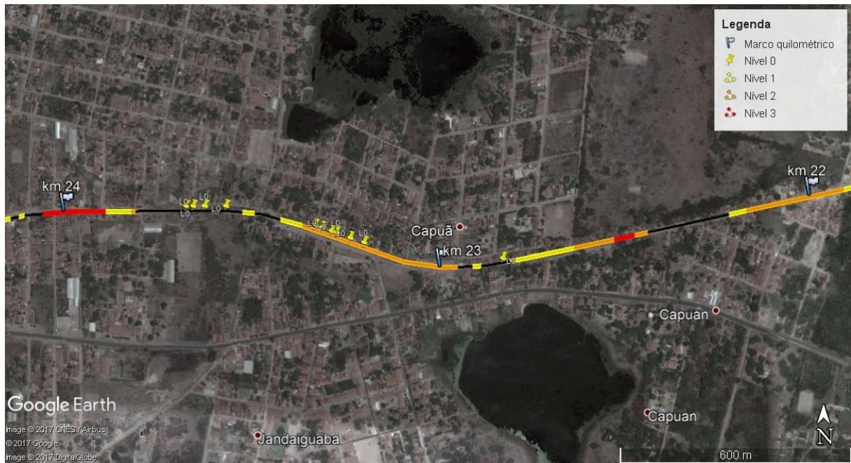
Figura 34 – Subtrecho com indicação da ocorrência de defeitos no lastro e respectiva severidade
