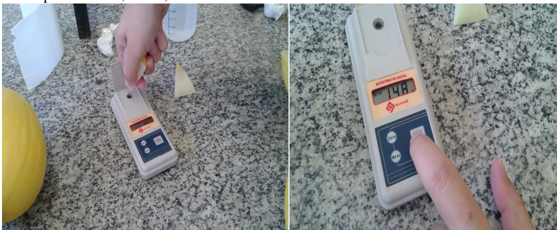
Figura 08 – Determinação do teor de sólidos solúveis no Laboratório de Fisiologia Vegetal da Embrapa. Fortaleza, Ceará, 2014.
