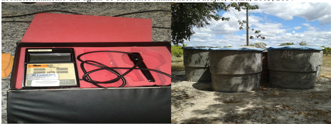
Figura 02 – Condutivímetro e caixas de fibra de vidro utilizadas no preparo e acondicionamento das águas de diferentes salinidades. Pacajus, Ceará, 2013, 2014
