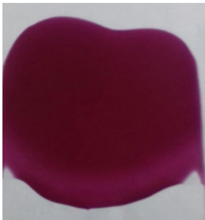
Figura 5 – Filme de amido de jaca com extrato de antocianinas
