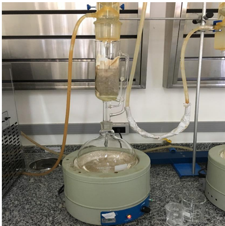
Figura 11- Sistema Soxhlet com solvente éter de petróleo
