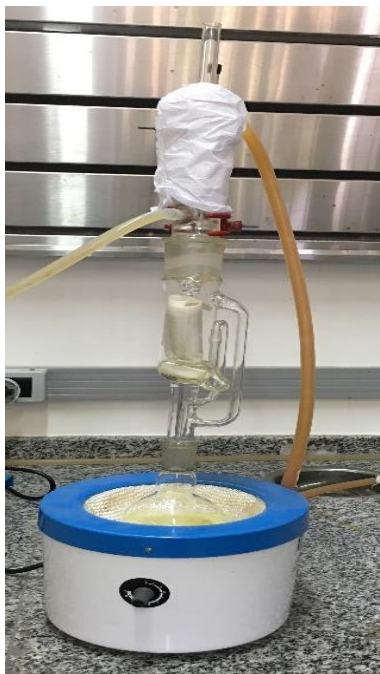
Figura 9: Sistema soxhlet da extração da Cucurbita pepo
