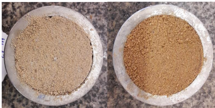
Figura 6 - Amostras de solos com 10 e 0% de cimento, respectivamente.
