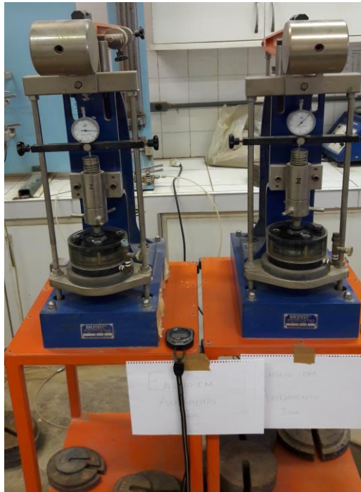
Figura 7 - Equipamentos de compressão oedométrica utilizados nos ensaios.
