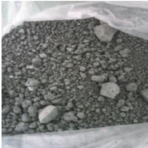
Figura 6 - Amostra de escória de conversor a oxigênio tratada pelo processo BSSF
