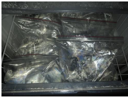
(c) colocação dos CPs a -18°C
