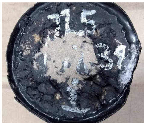
(c) Exemplo de CP com elevada macrotextura superficial
