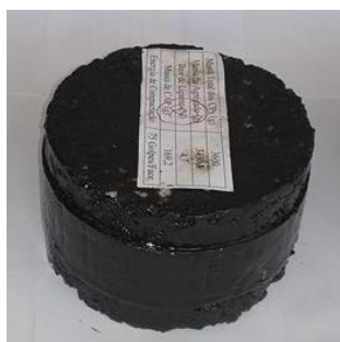
Figura 12 – Amostra após a aplicação de tinta impermeabilizante Neutrol na amostra
