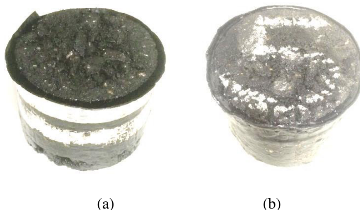
Figura 13 – Aplicação de manta asfáltica formando uma calha na parte superior do CP (a) e aplicação de CAP e da última demão de tinta Neutrol (b)
