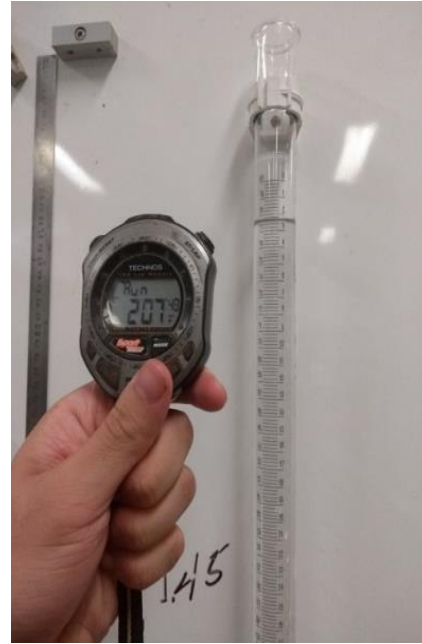
Figura 15 – Etapa final do ensaio de permeabilidade de misturas asfálticas
