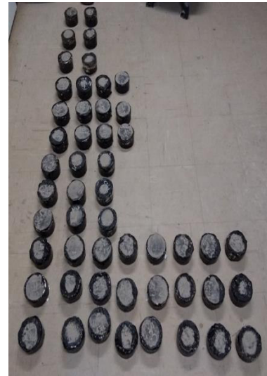
(b) Espalhamento da areia na superfície dos CPs
