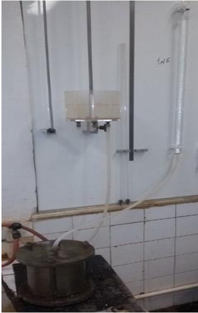
Figura 15 – Etapa final do ensaio de permeabilidade de misturas asfálticas
