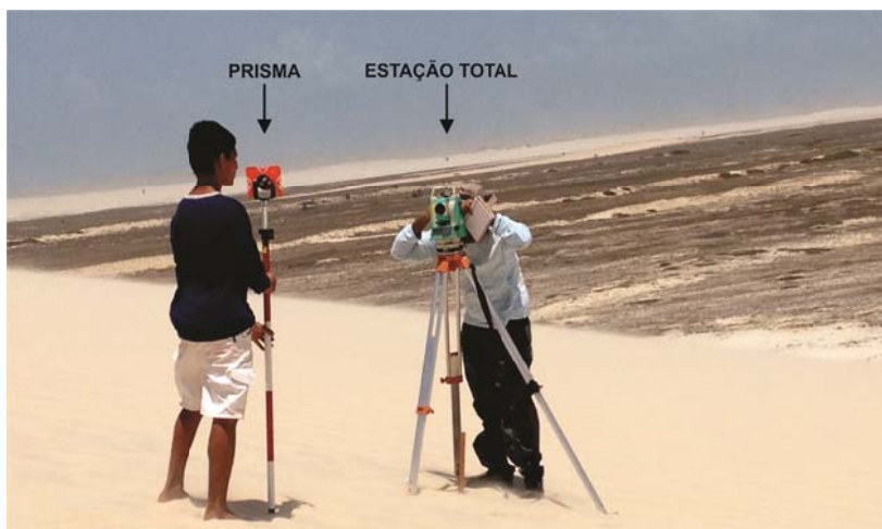
Figura 26 - Estação Total fazendo mira ao prisma.
