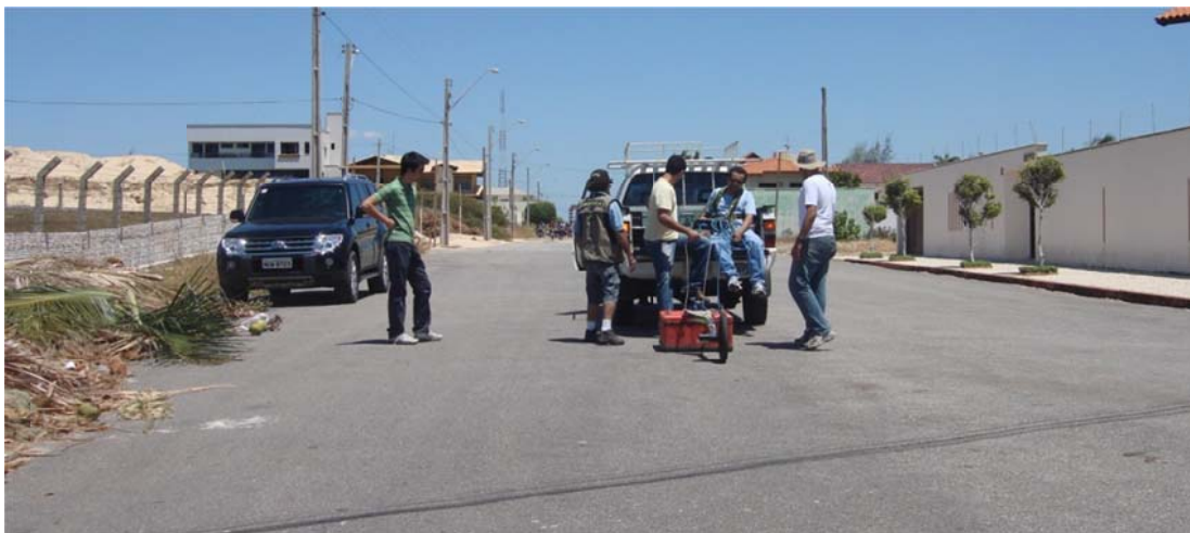
Figura 63 - Aquisição de GPR no Bairro Dunas usando a antena de 200 MHz com auxílio de veículo.
