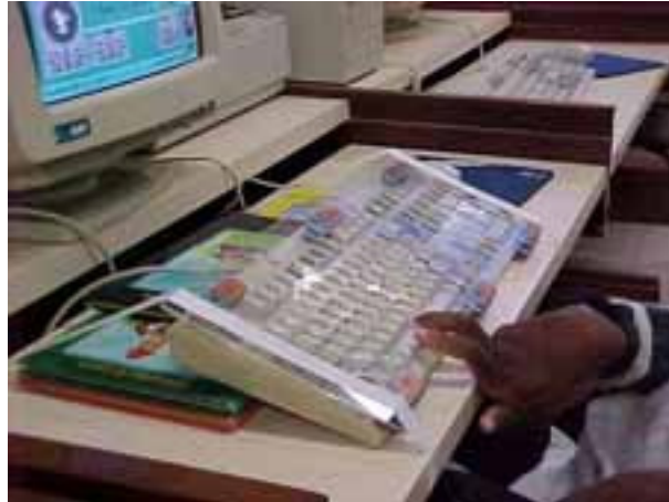
Figura 14 Teclado com Alteração de Inclinação e fixado na mesa
