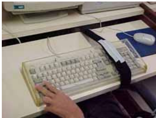
Figura 8 Máscara de teclado encaixada no mesmo
