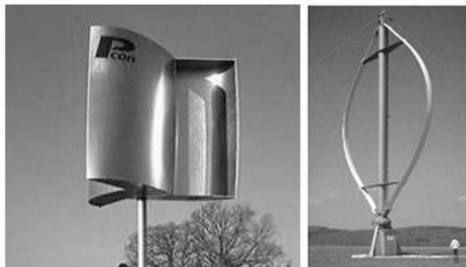
Figura 7 – Turbinas de arraste e de sustentação
