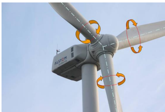
Figura 12 – Controle de passo nas pás de uma turbina eólica
