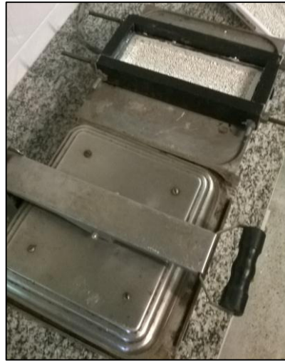
Figura 8. Molde sob aquecimento na chapa elétrica industrial.
