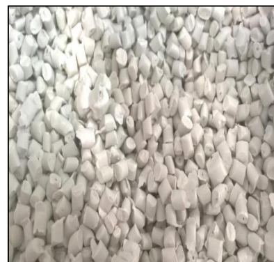
Figura 4. PPI. Reciclado na forma de grânulos.
