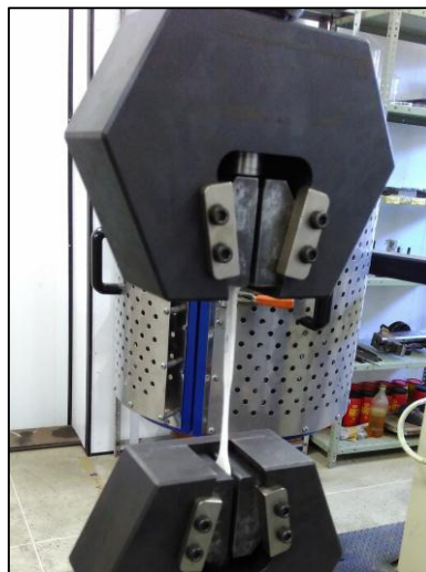
Figura 9. Ensaio de tração em compósitos
