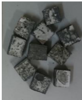
Figura 21: Placa cortada com 10 mm de espessura e amostras com aproximadamente 12 mm 2 .
