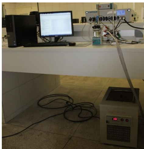
Figura 31: Teste de polarização potenciodinâmica cíclica realizado no LPC
