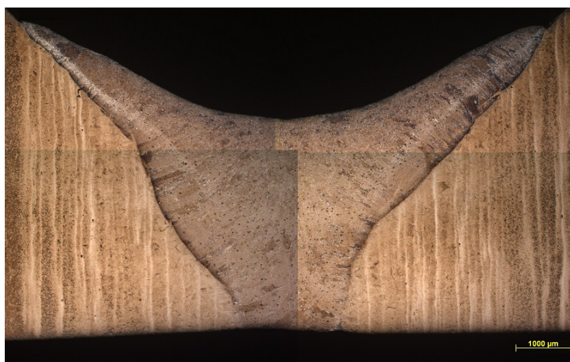
Figura 29 – Passe de raiz com CCC Soft com preaquecimento.
