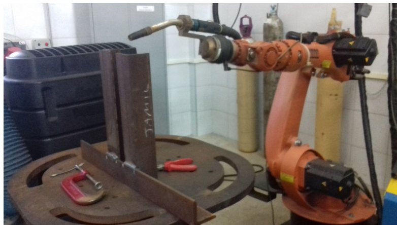
Figura 15 – Bancada de soldagem.
