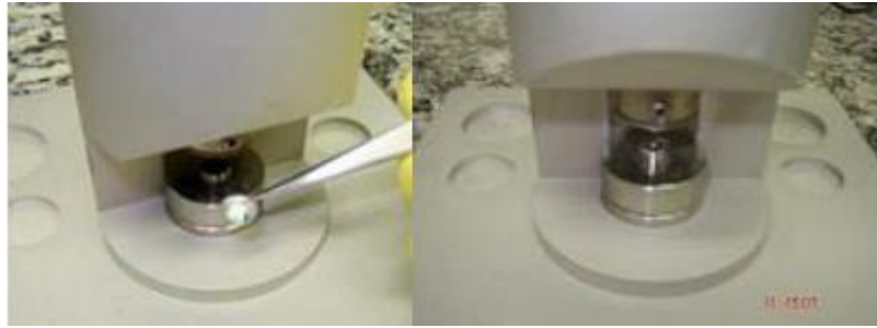
Figura 4.16 – Prensagem do cadinho
