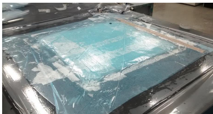
Figura 4.6 – Laminação dos tecidos com Vácuo.
