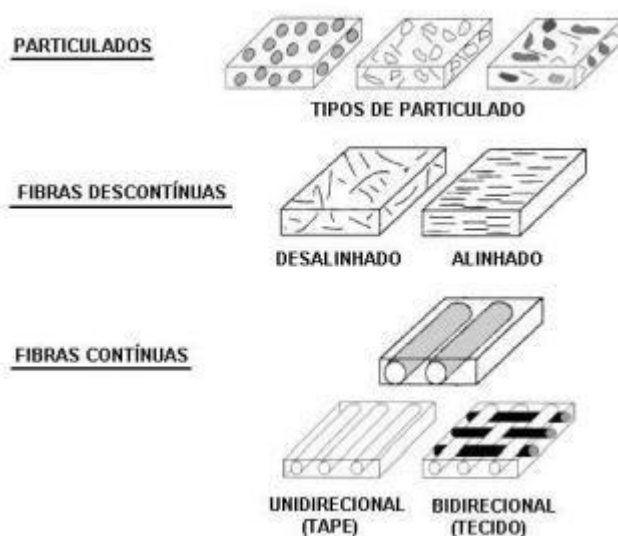
Figura 3.6 – Formas de distribuição do reforço na matriz polimérica.
