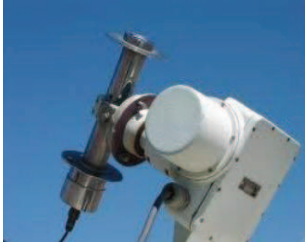
Figura C.3: Pireliômetro instalado em um rastreador
