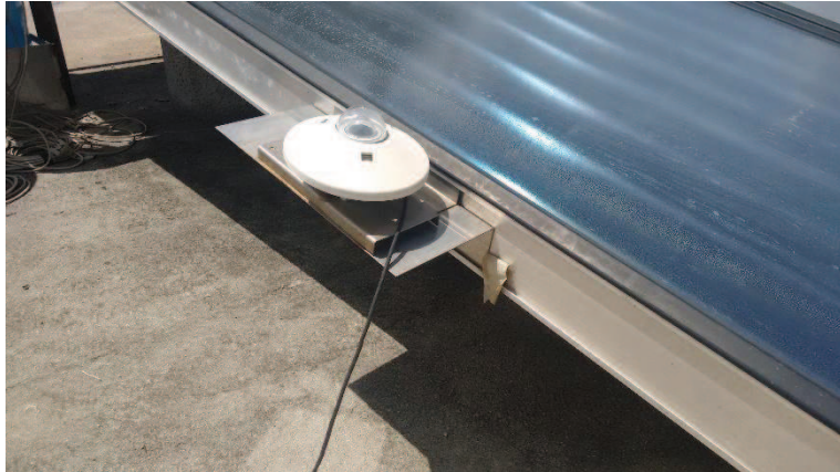
Figura D.3: Piranômetro na mesma inclinação do coletor
