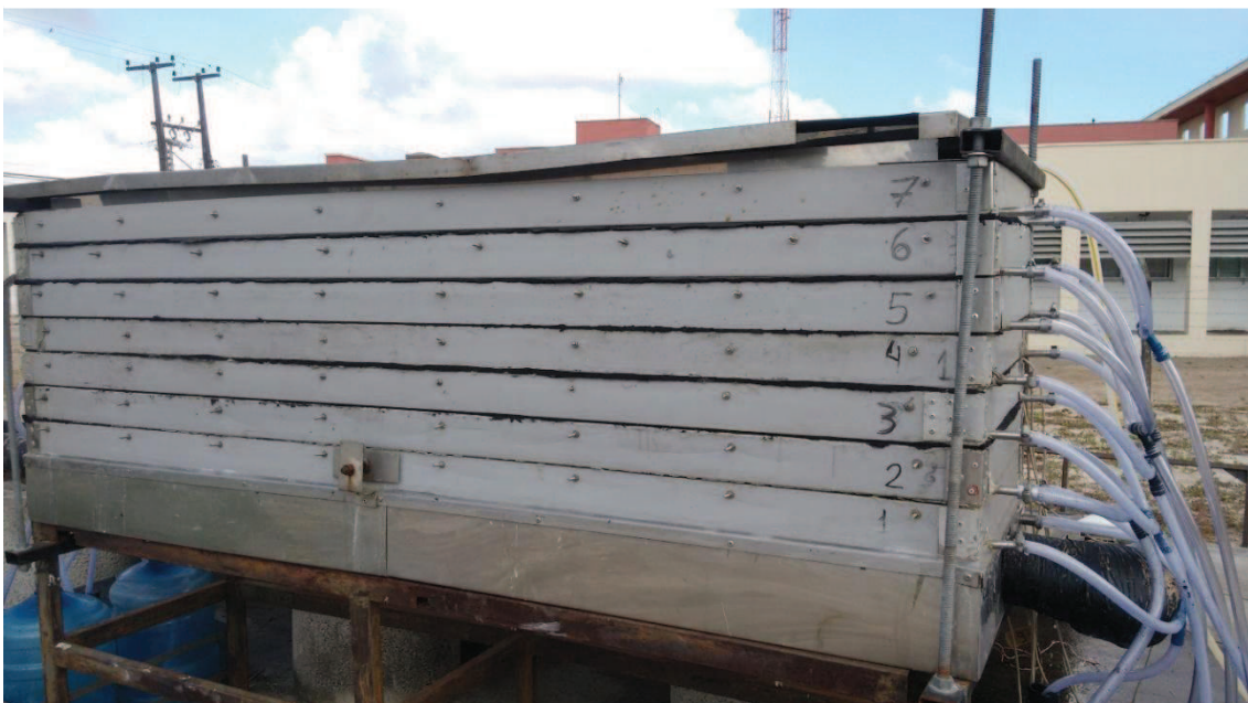
Figura 18: Torre de dessalinização
