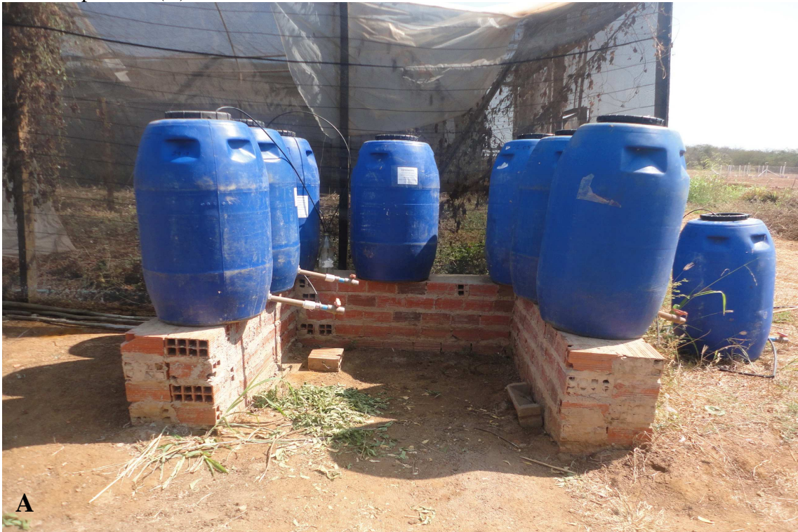
Figura 11: Vista geral do sistema de fabricação do biofertilizante (A) com detalhe para a saída do produto (B)
