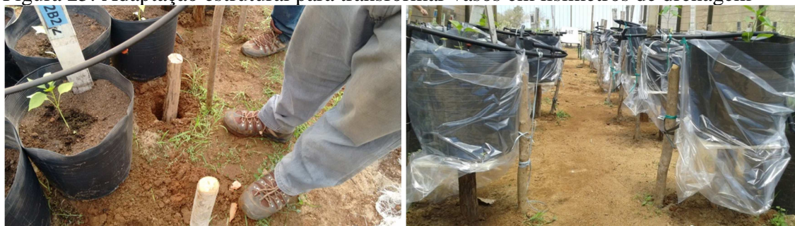
Figura 25: Adaptação estrutural para transformar vasos em lisímetros de drenagem
