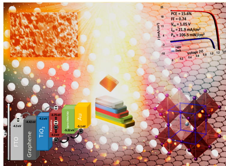
Figura 1.7: Células solares de perovskita com notável desempenho de até 15.6% de eficiência de conversão Adaptada da Ref. [47].
