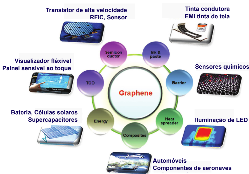
Figura 1.5: Visão geral das aplicações do grafeno em diferentes setores, variando de tinta condutora a sensores químicos, dispositivos de emissão de luz, ligas, energia, painéis sensíveis ao toque e eletrônicos de alta frequência. Adaptada da Ref. [34].
