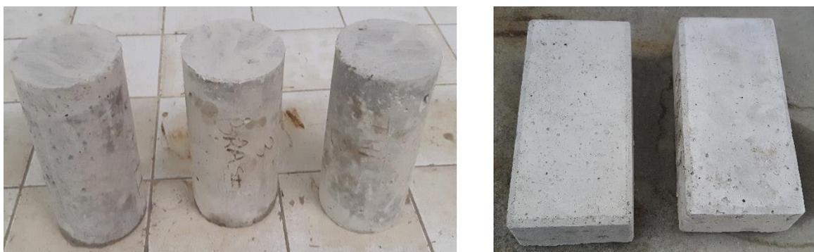
(a) CP's cilíndricos do traço com areia.
