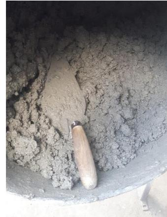
(c) Concreto depois da adição extra de água.
