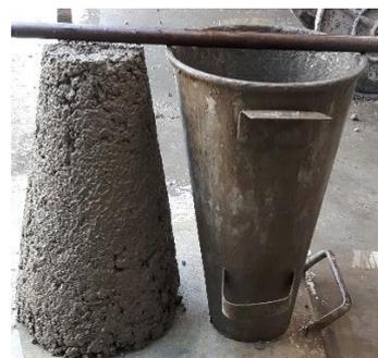
(c) *Slump test* no traço alternativo com brita areia.
