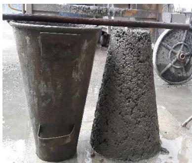
(b) *Slump test* no traço alternativo com brita 19 mm.
