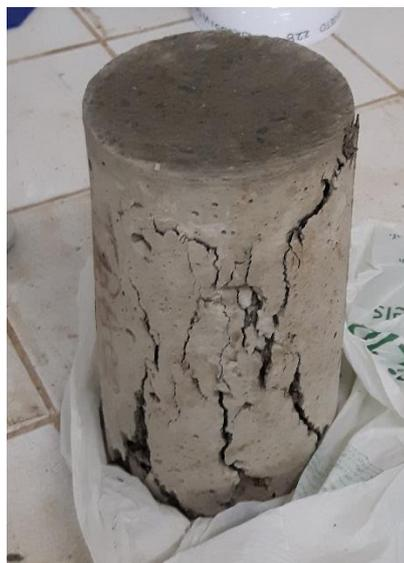
(a) CP cilíndrico rompido.
