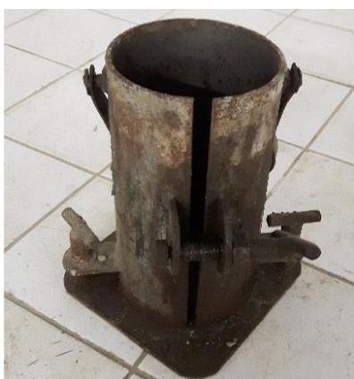
(a) Molde cilíndrico.
