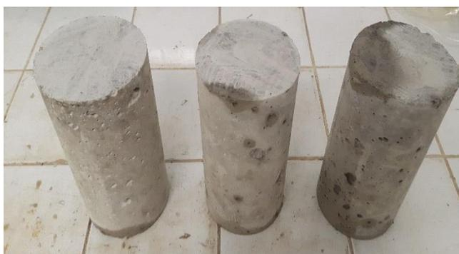
(a) CP's cilíndricos do traço de referência.
