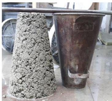
(a) *Slump test* no traço de referência.
