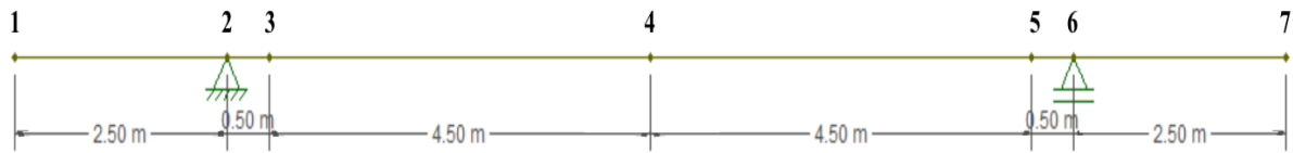
Figura 9 – Ponte discretizada para análise com grelha de barras, grelha de barra e placa, e placas
