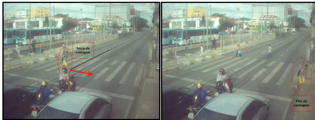
Figura 12 – Metodologia de contagem do tempo de travessia para cálculo da velocidade desejada
