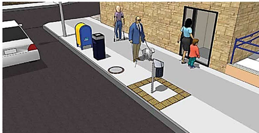
Figura 17 - Mobiliário urbano na faixa de serviço
