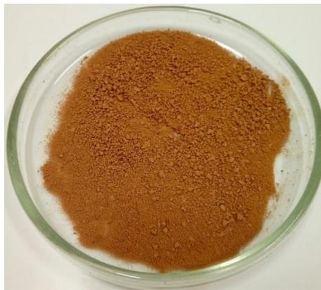
Condições de secagem: Temperatura = 160 °C; Fluxo de alimentação = 0,8 L/hora; Fluxo de ar = 40 L/min
