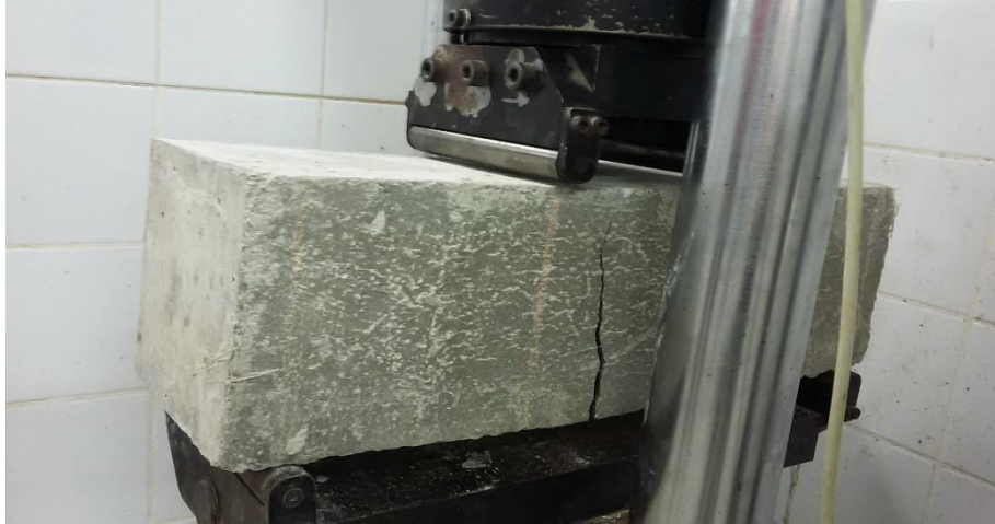
Figura 21 – Corpo de prova prismático com fibras poliméricas rompido.
