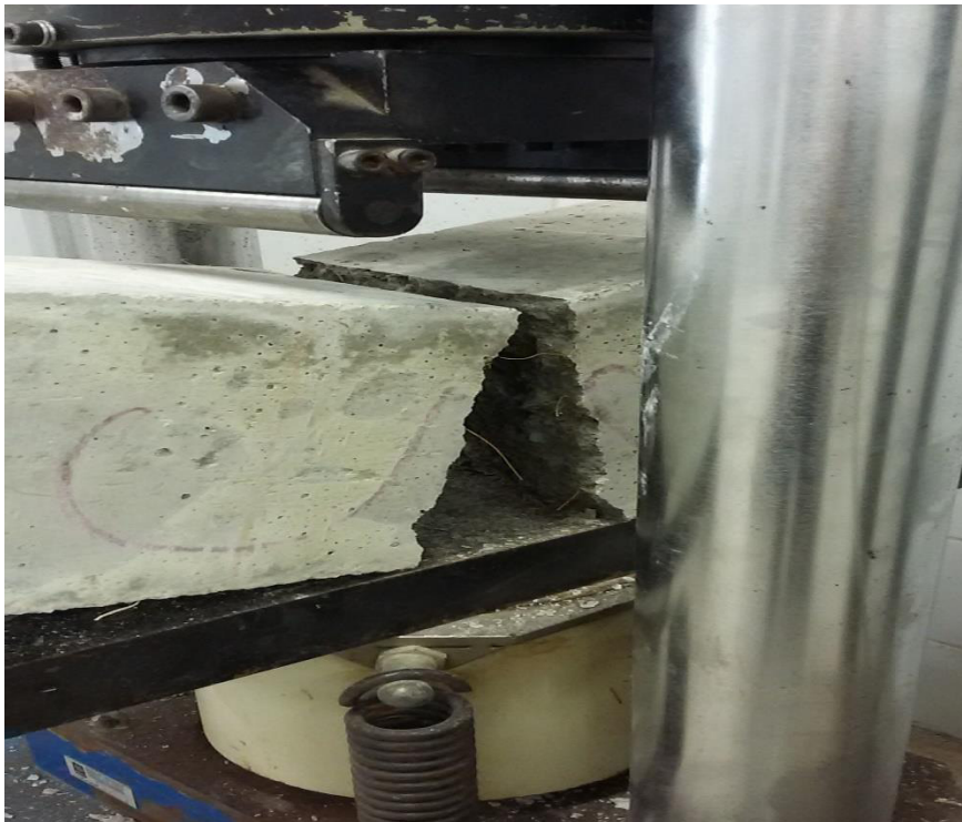
Figura 22 – Corpo de prova prismático com fibras de coco rompido.
