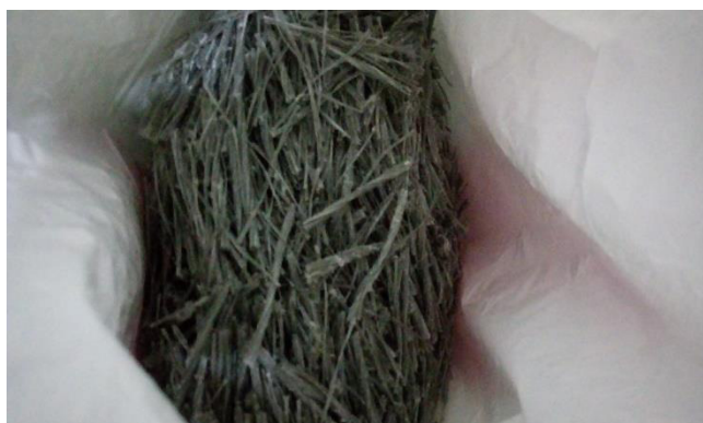
Figura 7 – Amostra de fibra polimérica.
