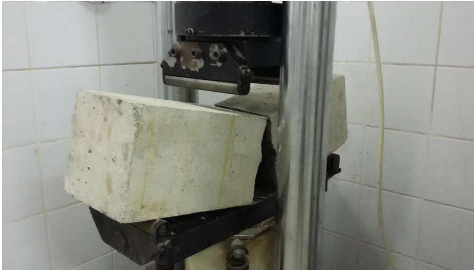
Figura 20 – Corpo de prova prismático de referência rompido.
